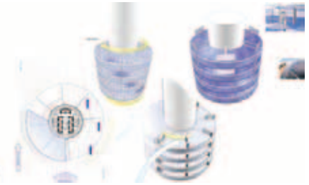
الشكل 08: توربينات الهواء المنتجة للطاقة والمركبة بين طوابق البرج
